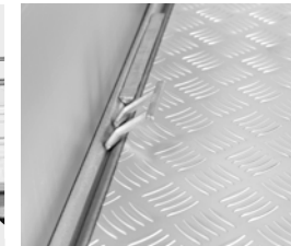
5 Anbindepunkte in V-Profil (Standard) / Alu- oder Stahlplatten- DIN Bodenbelag (Option) 400 daN (kg)
